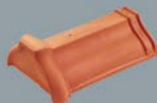
Gąsior początkowy nr 2 z otworem gwoździowym Waga: ok. 4,1 kg Rozstaw w świetle: 19,5 cm
