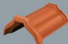
Gąsior nr 2 Waga: ok. 3,5 kg Zapotrzebowanie: 3,0 szt./mb Rozstaw w świetle: 19,5 cm Paleta: 60 szt.
